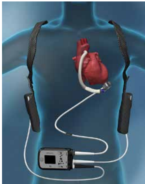
Abbildung 3: Linksherzunterstützungssystem mit Unterstützungspumpe am Herzen, Kontrollgerät und 2 Akkus zur Stromversorgung.
