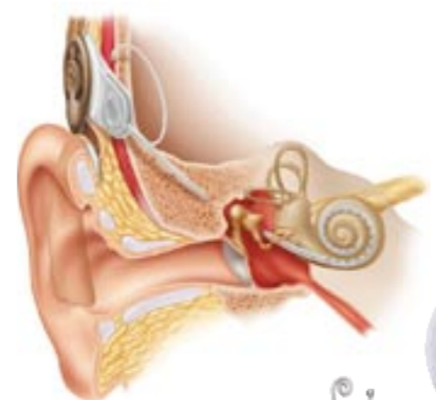
Schematische Darstellung einer Cochlea-Implantat-Versorgung (oben). Der Sprachprozessor befindet sich äußerlich hinter dem Ohr, das eigentliche Implantat (s. Abb. rechts) sitzt unter der Haut und hat Verbindung bis zur Elektrode in der Hörschnecke.
