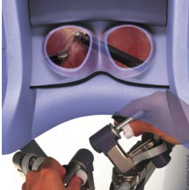
Abb 2: Übertragung der Bewegungen auf die Instrumente
